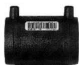
**MB Manchon électrosoudable avec butée PE 100 pour tubes SDR 11 à SDR 17,6 (Eau 16 bar, Gaz 10 bar).**
