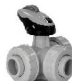
**ROBINET PP à tournant sphérique 3 voies. Percé en L. Embouts femelles à souder. Sièges PTFE. Joints EPDM ou FPM REF. TKDIM / L**
