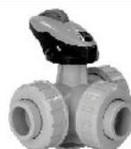
**ROBINET PP à tournant sphérique 3 voies. Percé en T. Embouts femelles à souder. Sièges PTFE. Joints EPDM ou FPM REF. TKDIM / T**
