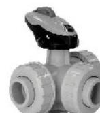
**ROBINET PP à tournant sphérique 3 voies. Percé en T. Embouts femelles pas du gaz. Sièges PTFE. Joints EPDM ou FPM REF. TKFM / T**
