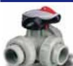
**ROBINET PVC-C 3 voies PN 16 - Siège PTFE Mâles à coller - Sphère percée en L - Joints EPDM ou FPM**
