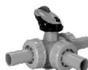
**ROBINET PP à tournant sphérique 3 voies. Percé en L. Embouts mâles en PP. Pour soudure par électrofusion ou bout à bout. Sièges PTFE. Joints EPDM ou FPM REF. TKBM / L**
