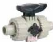
**ROBINET PP à tournant sphérique PN 10 avec embouts mâles à souder. Sièges PTFE. Joints EPDM ou FPM REF. VKDDM**
