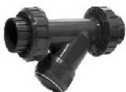
**FILTRE A TAMIS PVC PN 16 Union 3 pièces femelles taraudés En standard tamis PVC maille de 1,5 mm - Joints PDM**
