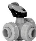
**ROBINET PP à tournant sphérique 3 voies. Percé en L. Embouts femelles taraudés pas du gaz. Sièges PTFE. Joints EPDM ou FPM REF. TKFM / L**
