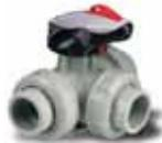
**ROBINET PVC-C 3 voies PN 16 - Siège PTFE Mâles à coller Sphère percée en T Joints EPDM ou FPM REF. TKDC / T**
