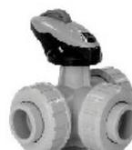
**ROBINET PP à tournant sphérique 3 voies. Percé en L. Embouts femelles à souder. Sièges PTFE. Joints EPDM ou FPM REF. TKDIM / L**
