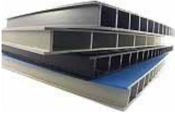
Les plaque alvéolaires sont un produit aux multiples possibilités d'utilisation. Elles sont fabriquées à partir de plaques en PE 100, PP, ou PPs, au moyen d'une technologie mécanique moderne exclusive ; elles se distinguent par une grande rigidité, un faible poids surfacique, une bonne isolation thermique et une grande facilité de mise en oeuvre. Elles peuvent être transformées avec les même méthodes que celles utilisée pour les thermoplastiques pleins.
