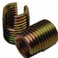
Inserts auto-taraudeurs avec filetage extérieur à pas fin, pour les matériaux plus durs. Cette série est disponible en acier cémenté ( finition zingué bichromaté), ainsi qu'en laiton et en inox. Elle est conçue pour l'aluminium et d'autres métaux non-ferreux, pour les plastiques thermodurcissant et les bois durs.
