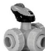
**ROBINET PP à tournant sphérique 3 voies. Percé en T. Embouts femelles pas du gaz. Sièges PTFE. Joints EPDM ou FPM REF. TKFM / T**
