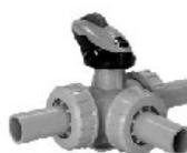
**ROBINET PP à tournant sphérique 3 voies. Percé en T. Embouts mâles en PP. Pour soudure par électrofusion ou bout à bout. Sièges PTFE. Joints EPDM ou FPM REF. TKBM / T**
