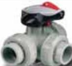
**ROBINET PVC-C 3 voies PN 16 - Siège PTFE Femelles à coller - Sphère percée en T - Joints EPDM ou FPM REF. TKIC / T**
