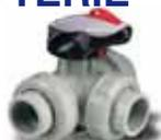
**ROBINET PVC-C 3 voies PN 16 - Siège PTFE Femelles à coller - Sphère percée en L - Joints EPDM ou FPM REF. TKIC / L**
