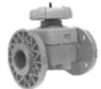
**VANNE A MEMBRANE PVC-C PN 10 Avec brides libres DIN 8063 PN 10. Encombrement DIN 3202 - Joints EPDM, FPM ou EPDM/PTFE - REF. VMOC**
