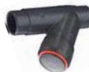
**FILTRE A TAMIS PVC PN 16 Mâles à coller En standard tamis PVC maille de 1,5 mm Joints EPDM**
