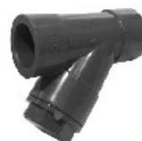
**FILTRE A TAMIS PVC PN 10/6 Femelles taraudés pas du gaz En standard tamis PVC maille de 1,5 mm Joints EPDM**
