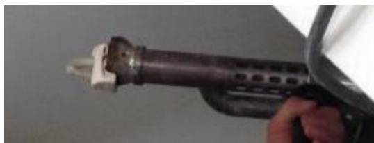
4. 1. Positionnez l'appareil de soudage par extrusion sous un angle de 45°.\* (Voir photo 4.1).
