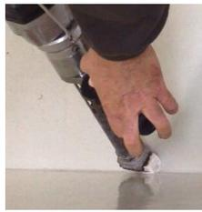
B. Soudage à air chaud : soudage à l'intérieur et à l'extérieur des panneaux, des côtés, du fond et du couvercle.
