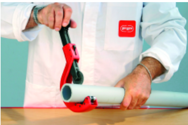
Foto 2: Taglio del tubo Cutting the pipe to length Coupe du tube Schneiden des Rohres
