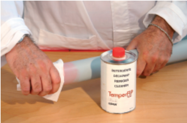
Foto 6 - 7 : Pulizia di tubo e raccordo con utilizzo del Detergente-Primer TemperFIP
