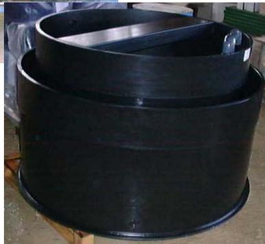
A gauche, cuve en PE avec support agitateur et rétention.
