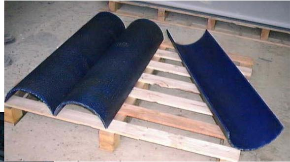
Ci dessus, formage en U de polyuréthane armé épaisseur 8 mm.
