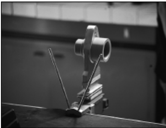
Foto 1: Apparecchiatura per la giunzione manuale di tubi e raccordi da saldare nel bicchiere Photo 1: Appareil pour la soudure manuelle des tubes et des raccords à souder dans l'emboîture. Photo 1: Appliance for manual joining of pipes and fittings by socket welding. Foto 1: Heizspiegel für die manuelle Heizelementmuffenschweißung von Röhren und Formteilen
